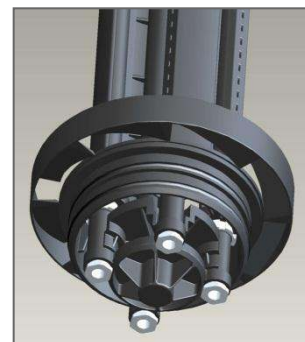
НИЖНЯЯ ЧАСТЬ ФИЛЬТРУЮЩЕГО ЭЛЕМЕНТА
